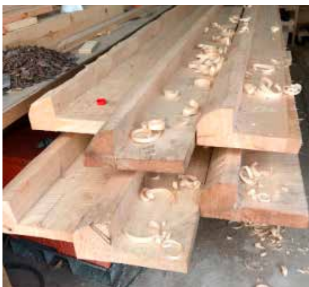
Nye takrenner er hugget ut med øks.
