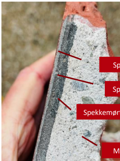
Bilde 42, Tverrsnitt av mørtelen. Lys grå (Murmørtel) er murmørtel. Sort spekkemørtel (Fugemørtel 1) er spekkemørtelen- Fugemørtel 2 med PC-2 er antatt fra 1938, og det noe lysere sjikt (Mørtellag) er spekkemørtel. Total tykkelsen på spekkemørtelen er 10-15 mm.
